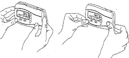
6. Insérer les deux piles AA fournies (uniquement modèle à piles).
